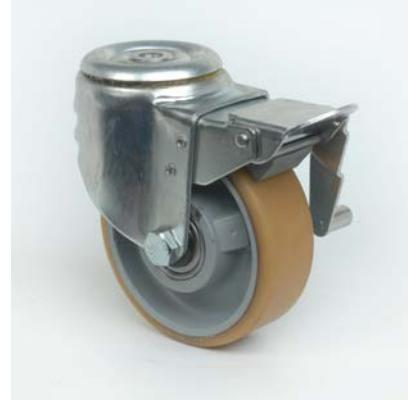
Wiel gietijzeren kern met elastische, vast opgegoten band in VULKOLLAN® 92° Shore A: kleur lichtbruin, zeer slijtvast, hoog draagvermogen - op precisiekogellagers.
