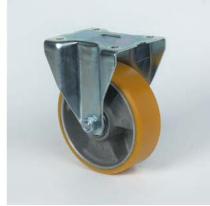
Wiel aluminiumkern met vaste elastische polyurethaanband 92° Shore A: kleur oranje, niet strepend, zeer slijtvast - op precisiekogellagers.
