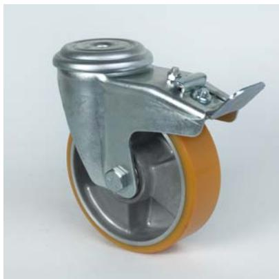
Wiel aluminiumkern met vaste elastische polyurethaanband 92° Shore A: kleur oranje, niet stregend, zeer slijtvast - op precisiekogellagers.
