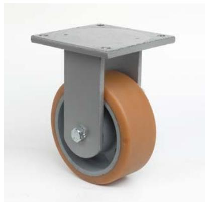
Wiel gietijzeren of staalgelaste kern met elastische, vast opgegoten band in VULKOLLAN® 92° Shore A: kleur lichtbruin, zeer slijtvast, hoog draagvermogen - op precisiekogellagers. Gemonteerd in een robuuste staalgelaste vork met dubbele kogelkrans: grijs hamerslag gelakt, afdichting, schokbestendig - types: zwenk, zwenk+rem, vast.
