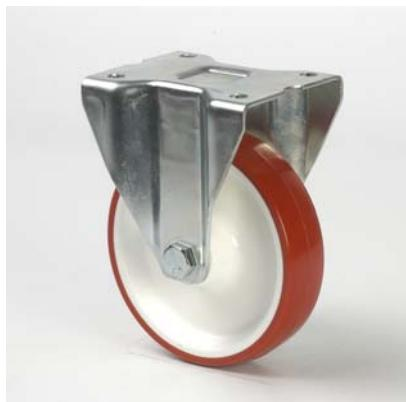
Wiel polyamidekern met loopvlak in gespoten polyurethaan 96° Shore A: kleur oranje, niet strepend, lage rolweerstand - op rollager.
